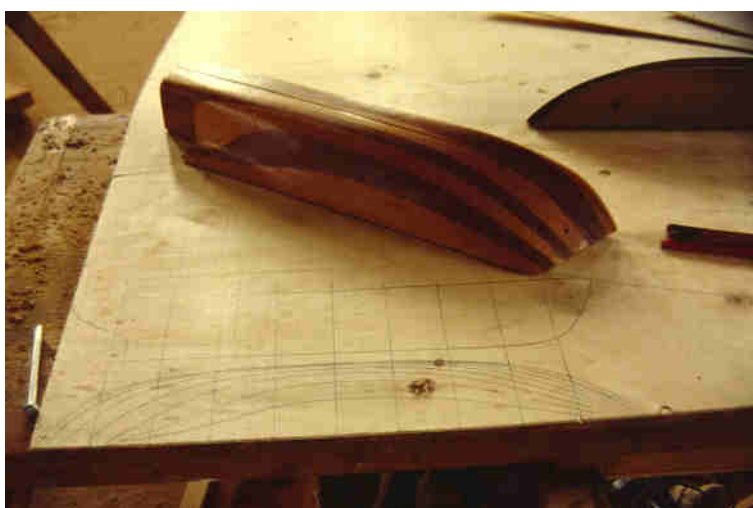
6. Il mezzo modello, usato prevalentemente nella tradizione di costruzione ligure.
