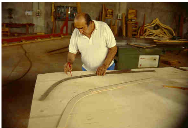
7. Porto Torres. Il maestro Pasquale Polese, che trae origine da Torre de Greco, disegna un'ordinata sulla base dell'uso del garbo.
